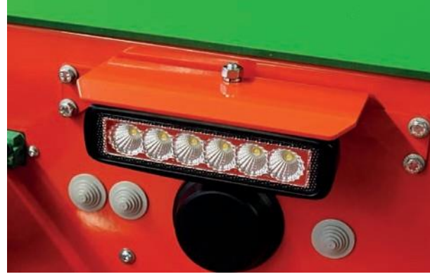
LED çalışma lambası – görsel uyarı fonksiyonlu Ref. 9679211
