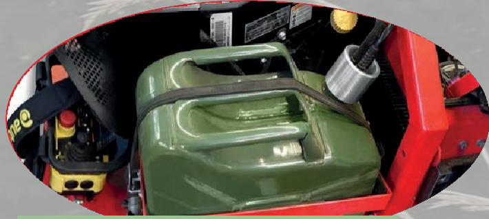
Agria'nın Çıkartılabilir yakıt tankı sistemi
