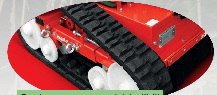
Zemine zarar vermemek için düşük ağırlık merkezi ve kauçuk paletler
